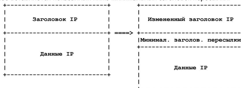
Заголовок IP исходной дейтаграммы изменяется и после него вставляется минимальный заголовок пересылки, за которым следуют данные IP (payload) из исходной дейтаграммы (например, транспортный заголовок и данные). В дейтаграмму не добавляется другой заголовок IP.
