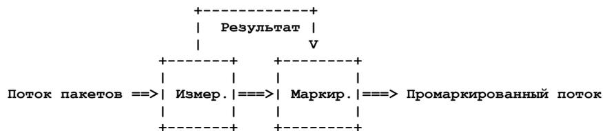
Измеритель работает в одном из двух режимов. В «слепом» режиме (Color-Blind) предполагается, что поток пакетов «не окрашен», а в режиме Color-Aware измеритель знает, что тот или иной элемент уже «окрасил» каждый пакет потока зеленым, желтым или красным цветом. Детали этой предварительной маркировки, включая обработку ошибок и способ обнаружения маркировки зависят от домена дифференцированного обслуживания (DS) и выходят за рамки документа.
