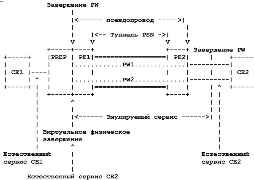
Рисунок 3. Предварительная обработка в эталонной модели PWE3.
