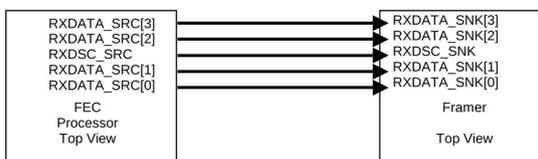
Рисунок 11. Соединение устройств SFI-5.2.
