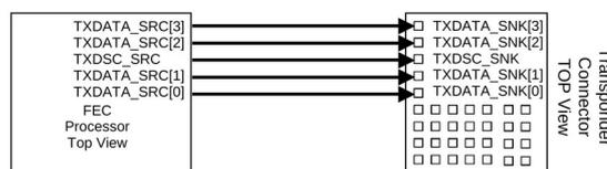
Рисунок 10. Линии между устройством SFI-5.2 и приемопередатчиком.
