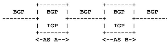
Из приведенной диаграммы видно, что BGP служит для передачи информации между AS, а внутри каждой автономной системы может использоваться как BGP, так и IGP. Обеспечение совместимости маршрутной информации между протоколами BGP и IGP внутри AS имеет важное значение и рассматривается в Приложении А.
