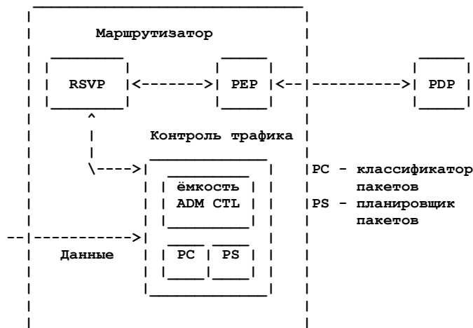
Рисунок 3. Связь между PEP и другими компонентами int-serv в маршрутизаторе RSVP.
