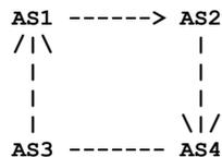
Канал AS3-AS4 должен в этой схеме использоваться лишь в тех случаях, когда соединение AS2-AS4 перестает работать (для исходящего трафика AS4 просто делает маршруты, полученные от AS2, более предпочтительными). Такое решение повсеместно используется в современной сети Internet. Отметим, однако, что в данной конфигурации имеется и другое стабильное решение, показанное на рисунке.
