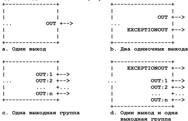
Рисунок 3. Примеры LFB с разными выходными комбинациями.
