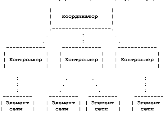
Рисунок 2. Пример архитектуры SDN.
