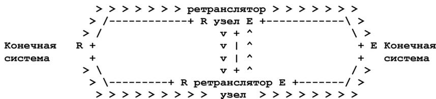
Рисунок 1. Репликация и исключение потоков.
